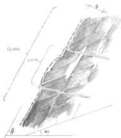
Figura 2 – Pendio con la superficie instabile erosa
